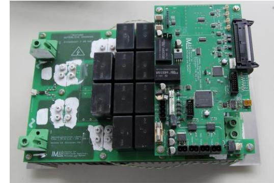
Erster Prototyp für Prüfstandversuche
