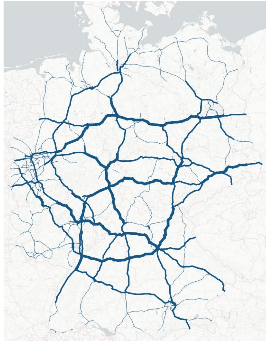
Abbildung: Ladebedarfe auf der Bundesautobahn durch schwere Nutzfahrzeuge im Fernverkehr basierend auf aggregierten Mautdaten
