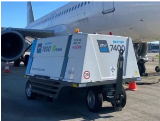
Abbildung 8: Beispiel einer batterieelektrischen GPU, ITW GSE 7400 eGPU, (Bildquelle: ITW GSE, 2024)
