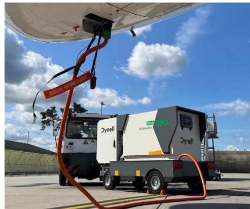
Abbildung 7: Beispiel einer batterieelektrischen GPU, Dynell DEM 090 (Bildquelle Dynell, 2024)
