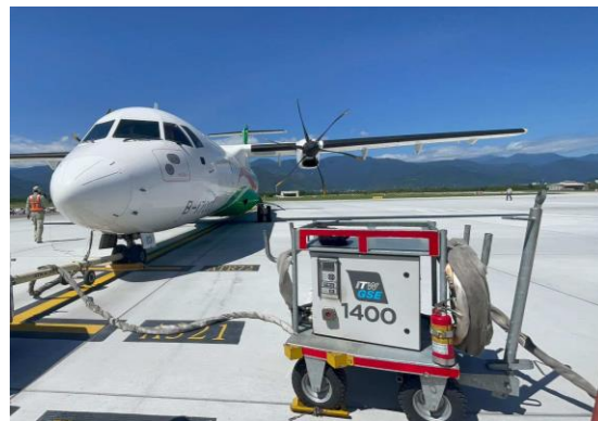
Abbildung 6: Beispiel einer statisch mobile Bodenstromanlage, anhängermontiert, ITW GSE 1400 solid-state 28 VDC GPU (Bildquelle: ITW GSE, 2024.)
