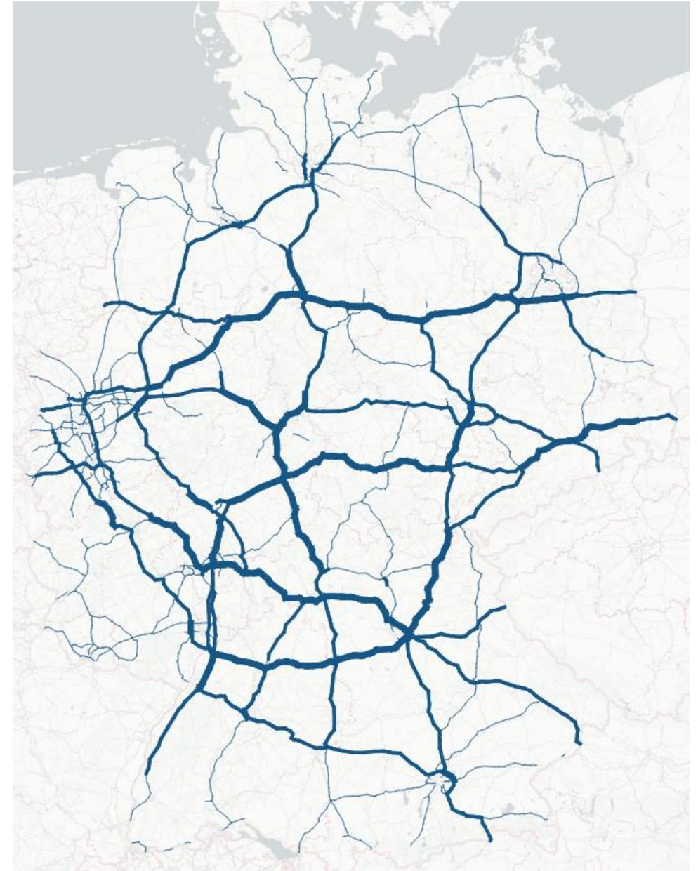
Abbildung: Belastung des Autobahnnetzes durch schwere Nutzfahrzeuge im Fernverkehr, Datengrundlage Toll-Collect (Mautdaten)
