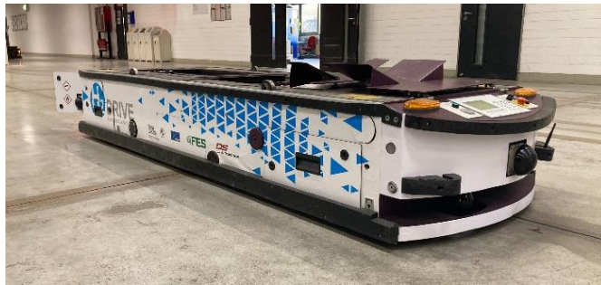
Umgebautes FTF mit H2 E-Pack Brennstoffzelle
