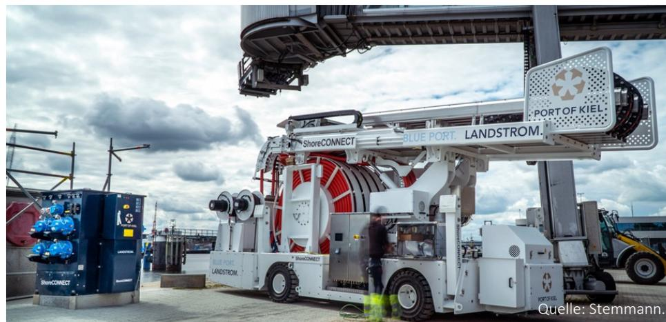
Die Logistik im Anlegebereich wird während der Verweildauer des Schiffes grds. nicht beeinträchtigt. Die Versorgung mit unterschiedlichen Frequenzen und Spannungen (min. 16 MVA bei 11 kV o. 6,6 kV, 50/60 Hz) sowie ein Tidenhubausgleich von bis zu 9 Metern ist möglich.
