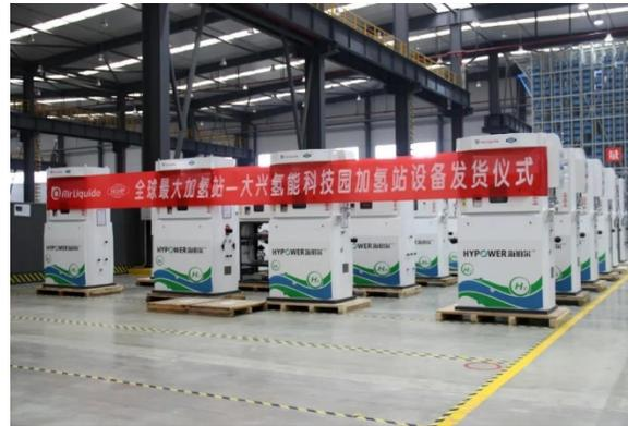
Betankungsanlage von Air Liquide Houpe für Daxing HRS (4.800 kgH<sub>2</sub>/d) in Beijing [555]
