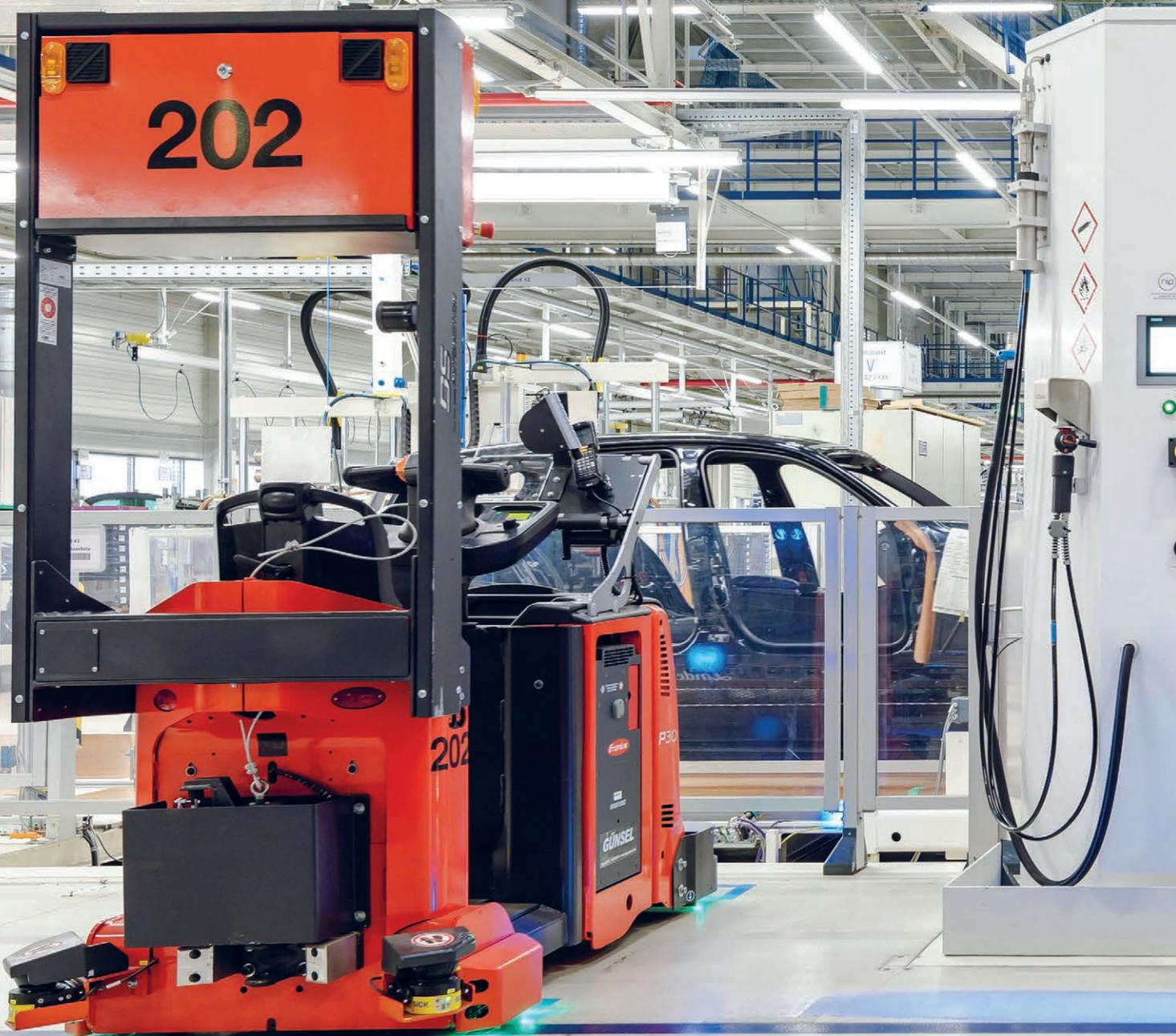
Brennstoffzellen im Einsatz: Im BMW-Werk Leipzig erledigen 70 wasserstoffbetriebene Routenzüge (Indoor-Schlepper) von Linde Material Handling die Intralogistik.
