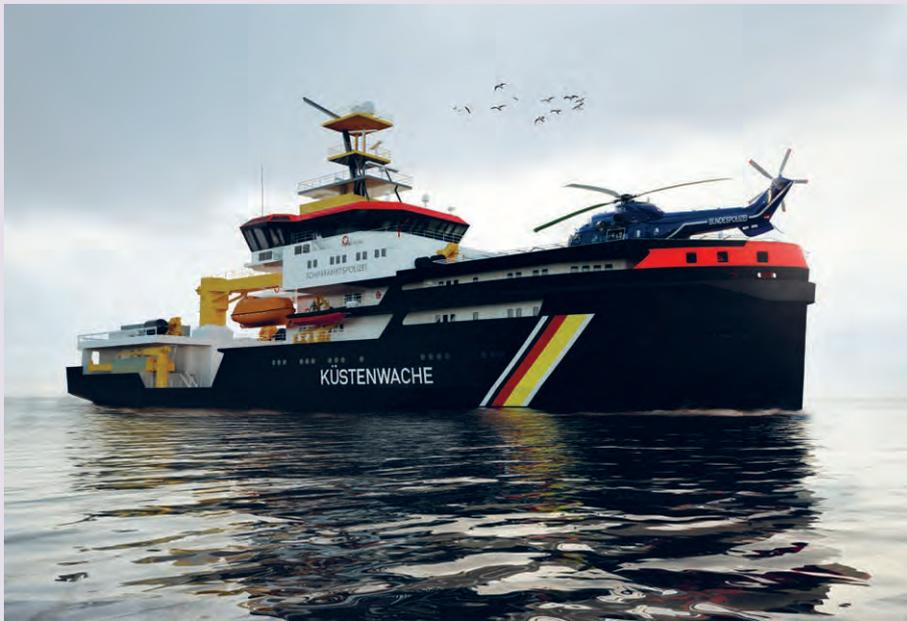
Für die Wasser- und Schifffahrtsverwaltung des Bundes werden in den kommenden Jahren drei neue Spezialschiffe mit LNG-Antrieb gebaut.
