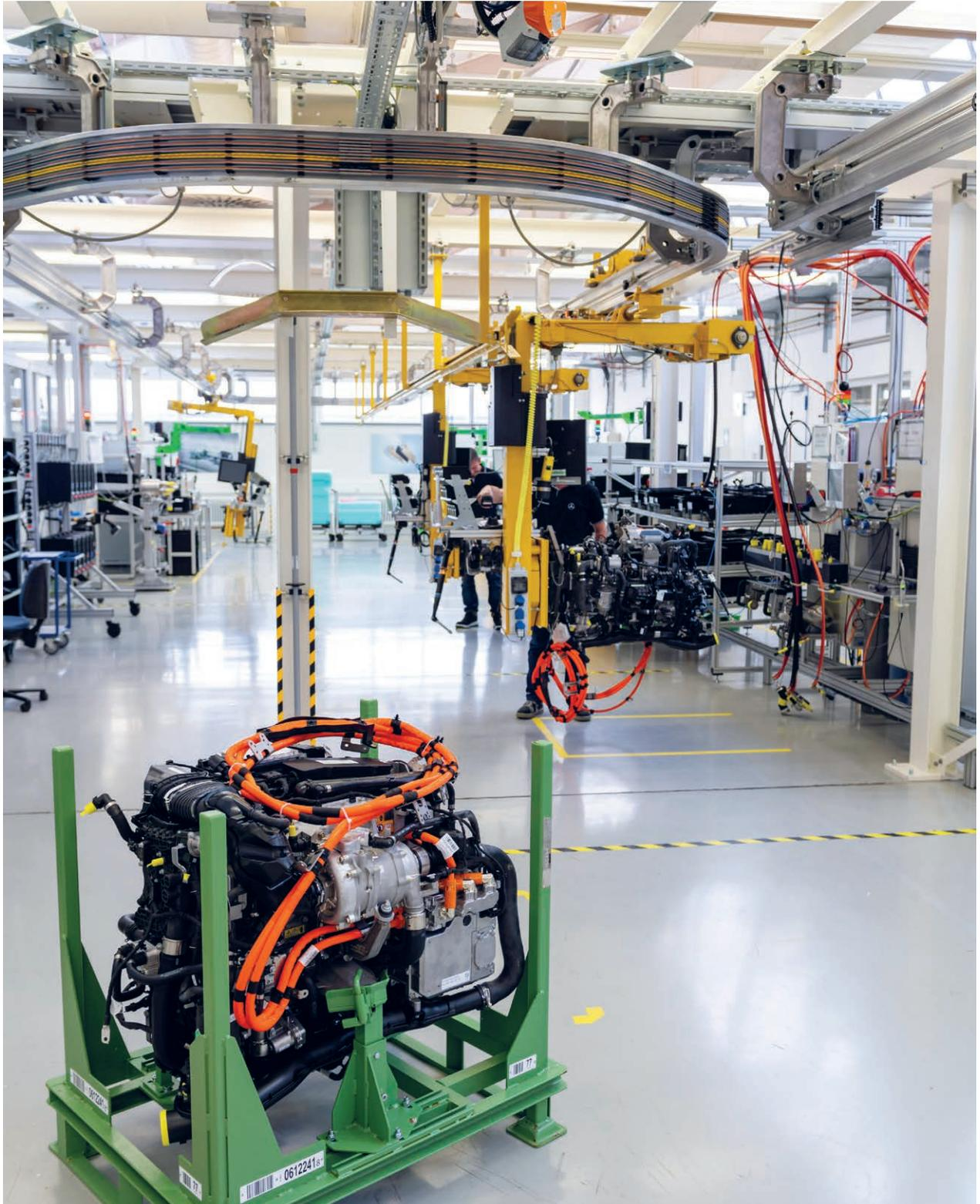
Vorbereitungen für die Serienproduktion von Brennstoffzellen bei der Daimler Truck AG
