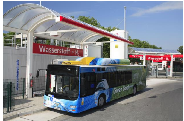
Emissionsfreier öffentlicher Personennahverkehr mit Brennstoffzelle und Wasserstoff aus Erneuerbaren Energien (Quelle: Clean Energy Partnership)
