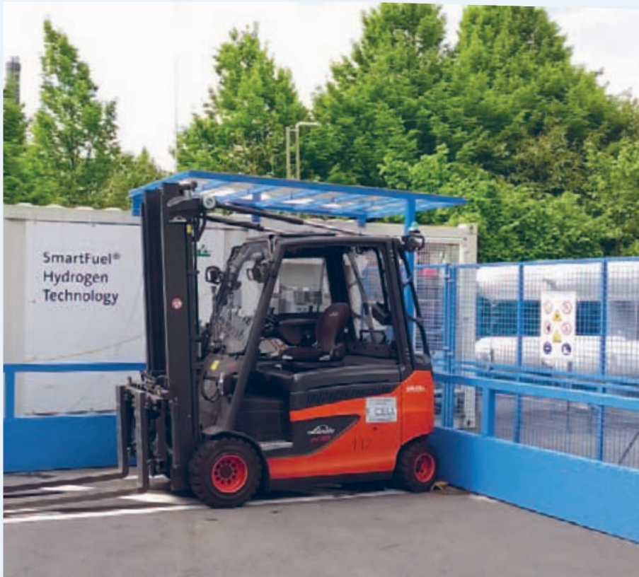
Gabelstapler mit Brennstoffzellenantrieb im innerbetrieblichen Logistikverkehr
