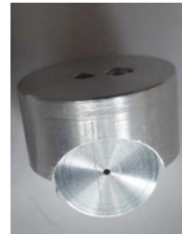
Aufnahme der Stimmgabel im oberen Teil des Swagelok-Verbinders
