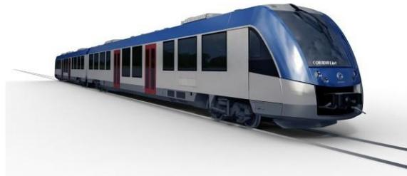
*Abbildung 6: Designbild des Coradia LINT 54, Basis für den zukünftigen brennstoffzellenbetriebenen Hybridtriebzug; Copyright Alstom*
