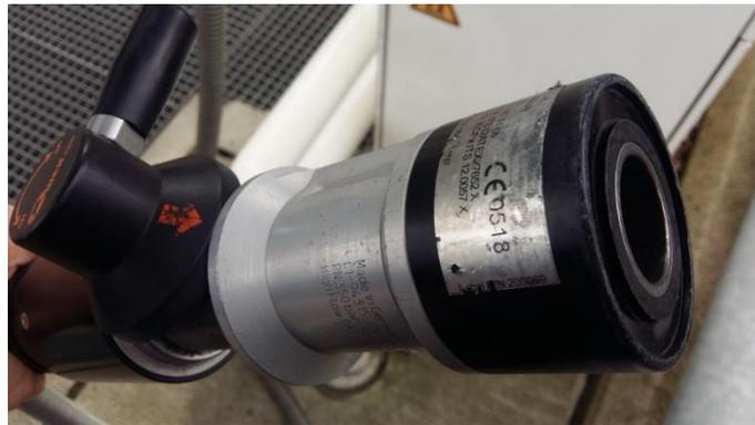
Abbildung 43: Zapfsäule und Füllkupplung für die Betankung von Bussen in Hamburg Oberbaumbrücke (Quelle: Signon)
