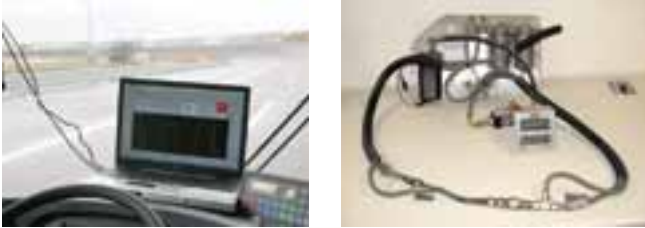
ABBILDUNG 6: MESSFAHRT AUF DEM LAUSITZRING (LINKS) UND EINGESETZTES DURCHFLUSSMESSGERÄT (RECHTS) (MR SACHSEN)
