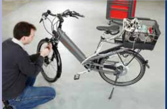
PEDELEC MIT MESSTECHNIK DES FRAUNHOFER-INSTITUTS FÜR BETRIEBSFESTIGKEIT UND SYSTEMZUVERLÄSSIGKEIT LBF
