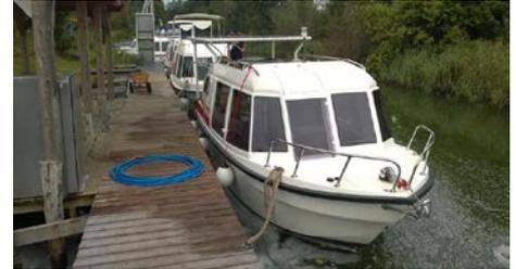
Die wesentlichen Kenngrößen der Elektro-Hausboote sind die folgenden: Elektromotor Torqeedo, Antriebsleistung 2 kW - 2x2 kW - 2x1 kW, Leistung PV-Modul 2 kWp, Batterietyp Li-Ion, Kapazität 400 - 600 Ah, Batteriespannung 20,8-28,8 V, Brennstoffzelle PEM, BZ-Leistung 0,5 kW - 1 kW - 2 kW, Ausgangsspannung 12 - 24 - 48 V, Wasserstoffspeicher Carbon Faserverbund Typ 4, Hersteller Dynetek, Druck 350 bar, Ausgangsdruck für BZ 1,3 bar.
