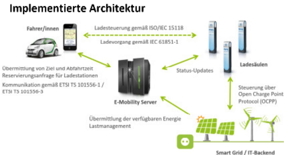
Abb. 51: Im eMERGE-Projekt entwickelte Architektur zur Realisierung der automatisierten Ladesäulenreservierung und zur Unterstützung von gesteuertem Laden
