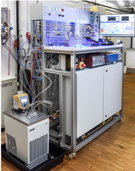
Abb. 02: Neue Generation von Einzel-Testständen des Fraunhofer ISE
