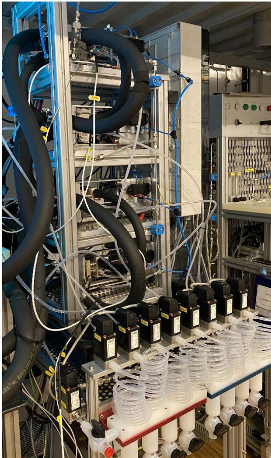
Abb. 04: 4fach-Aufbau mit wassergeführter Gastemperierung und Kondensations-einheit zum Auffangen des Produktwassers von Anode und Kathode getrennt für die 4 Testzellen
