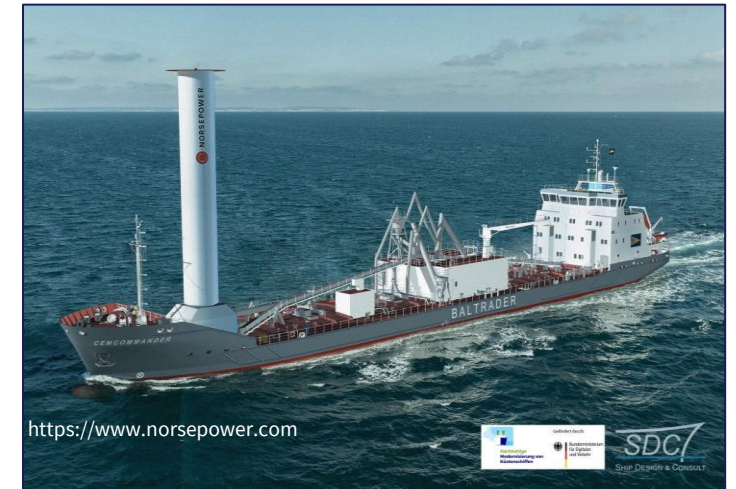
Ausrüstung „Cemcommander“ mit einem Rotorsegel. (BRISE Bereederung)
