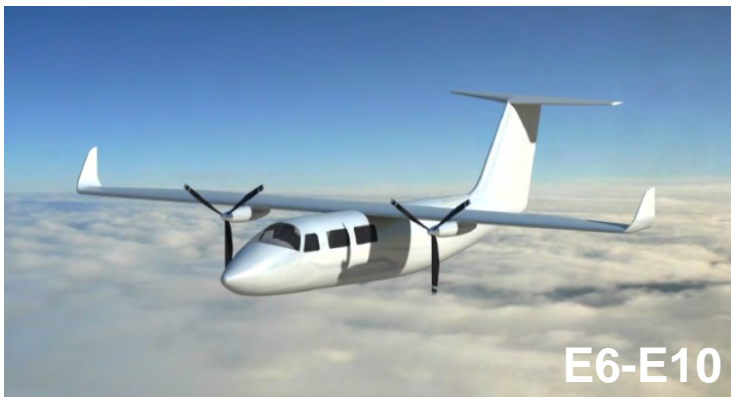
Scylax Aircraft, E10: 10 Sitzler, 2 260kW E-Motoren u. Batt.; Erstflug geplant 2022
