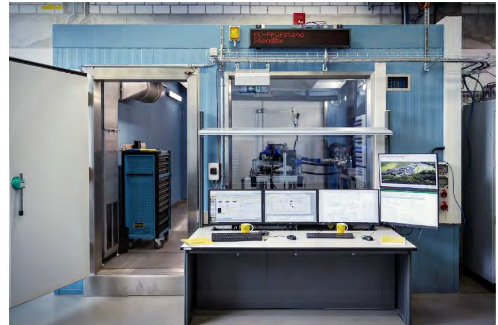
Abbildung 5: Brennstoffzellen-Systemprüfstand (Prüfkammer ohne Nebenaggregate) nach Inbetriebnahme (Foto: LICHTMEISTER Photography Productions e.U.)
