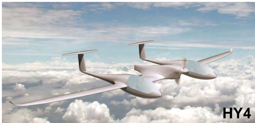
H2Fly Hy4, 4-Sitzer, 120kW BZ-Batt.-Hybrid; Erstflug 2016
