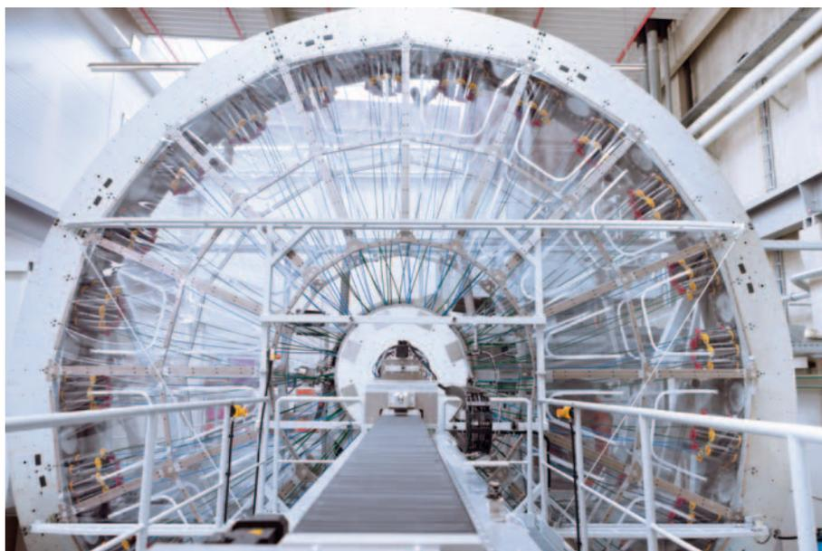
Flechtrad zur Herstellung von carbonfaserverstärkten Wasserstoffdrucktanks im REHAU-Leichtbautechnikum in Viechtach
