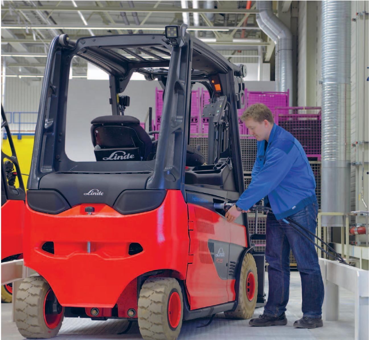
Wasserstoffbetankung bei einem brennstoffzellenbetriebenen Gabelstapler
