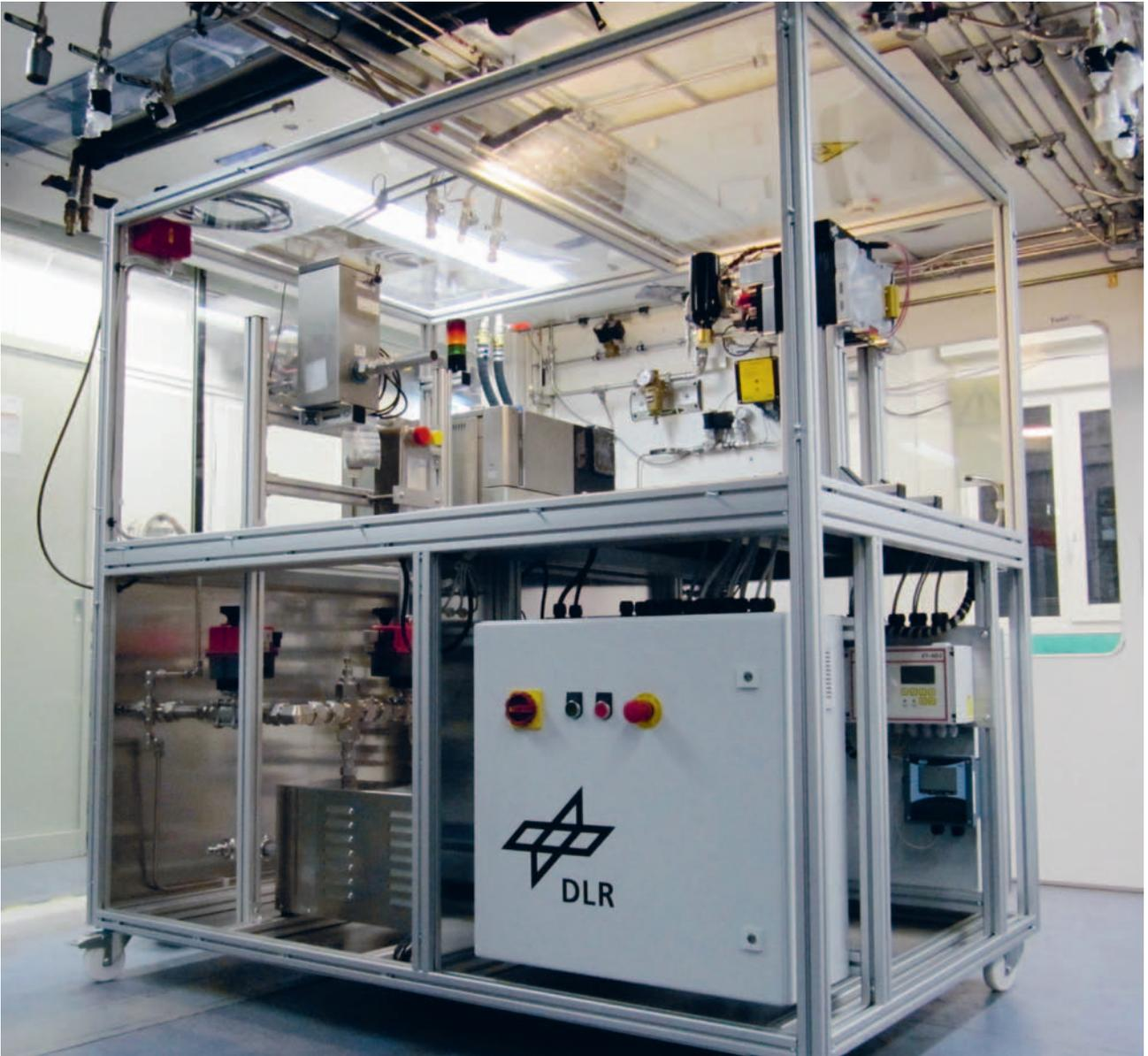
Aufbau des BeZel-Teststands zur experimentellen Untersuchung der Lebensdauer des Brennstoffzellensystems unter luftfahrtspezifischen Betriebsbedingungen
