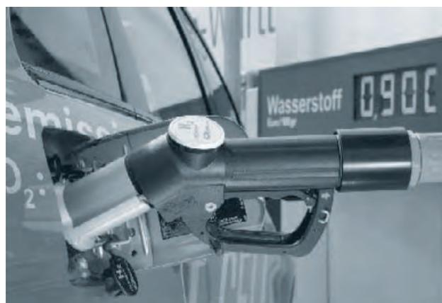
Wasserstoff im Tank – Mercedes-Benz B-Klasse F-CELL
