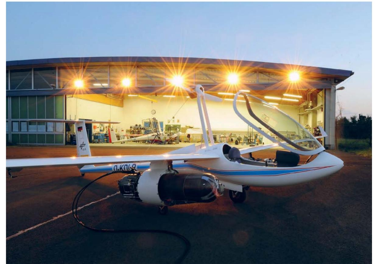
Das Brennstoffzellenflugzeug Antares DLR-H<sub>2</sub> wird mit gasförmigem Wasserstoff betankt
