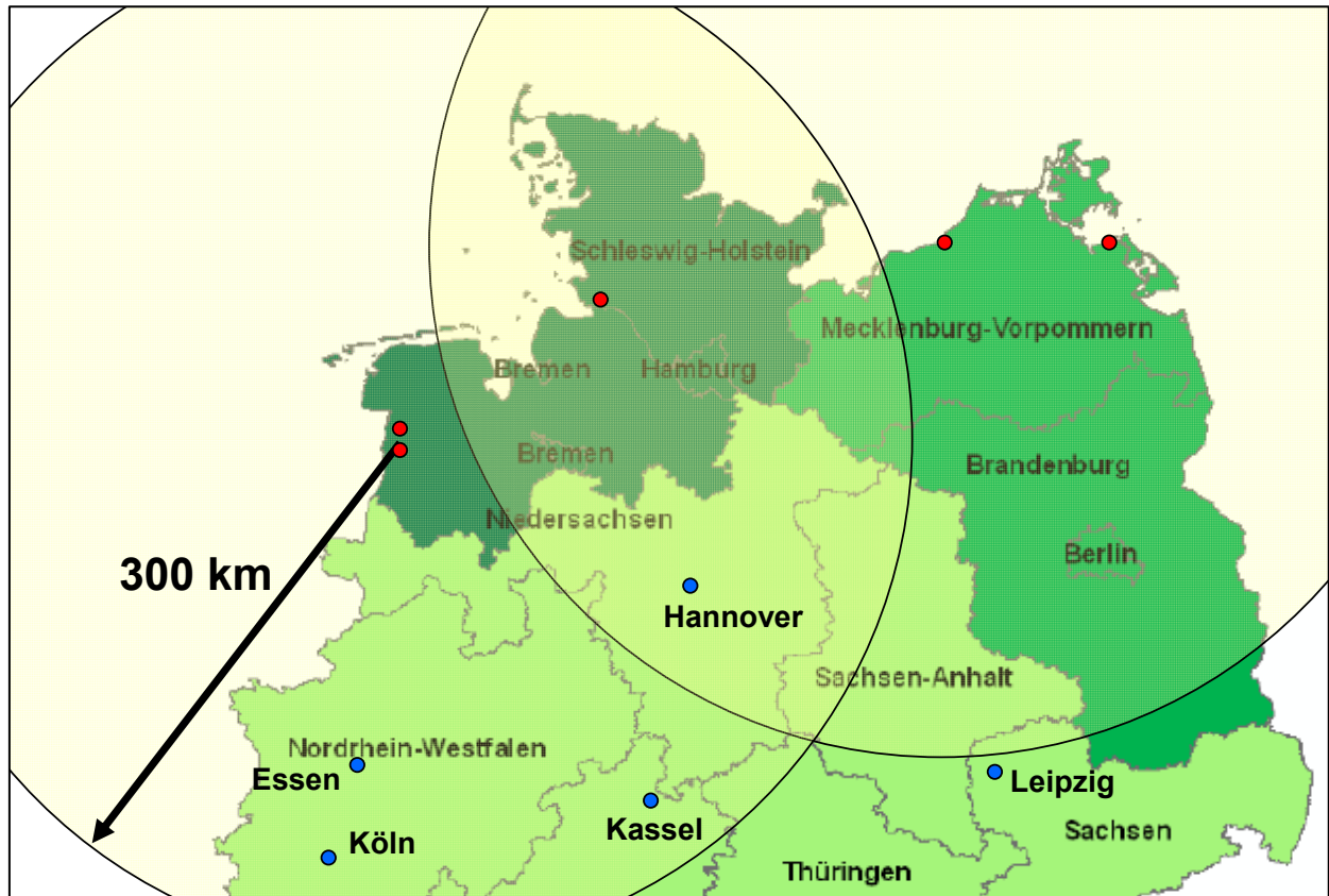
Abbildung 6-5: Einspeisepunkte von Offshore-Windstrom als mögliche Standorte von Wind-Wasserstoff-Systemen sowie Auslieferungsbereiche von H 2 -Kraftstoff im nördlichen Teil Deutschlands. Die Einspeisepunkte sind mit roten Punkten gekennzeichnet. Die beiden Kreise um Diele bzw. Dörpen und Bentwisch/Rostock zeigen ungefähr, welche Regionen versorgt werden können, wenn die einfache Fahrstrecke zwischen dem Standort des Wind-Wasserstoff-Systems und den zu beliefernden Tankstellen im Mittel 300 km betragen darf. Um Büttel und Lubmin sind keine eigenständigen Kreise eingezeichnet, weil von dort aus keine nennenswerten zusätzlichen Lieferbereiche erschlossen werden.
