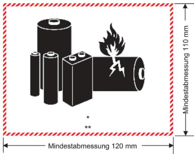
Abbildung 7: Neues Kennzeichen für Lithium-Ionen-Batterien
