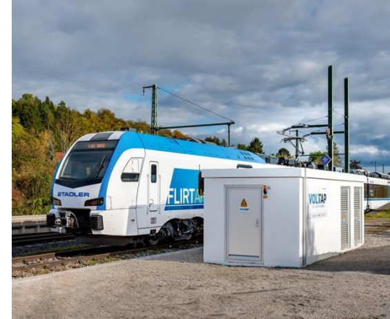
Abb. 13: STADLER Flirt Akku-Triebwagen beim Ladevorgang (Quelle: Stadler Deutschland GmbH)
